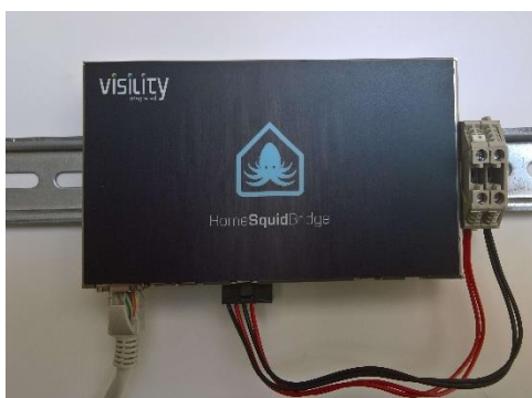
Visility HSB tilsluttet klemrækker for MODBUS i tavle.
